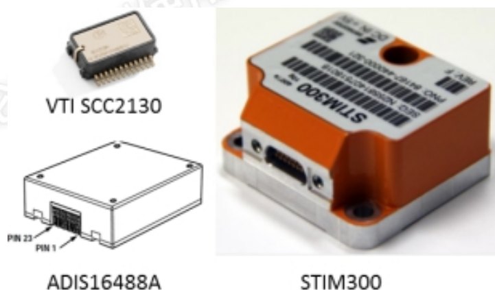
图 5-2 不同等级 MEMS IMU 外观
