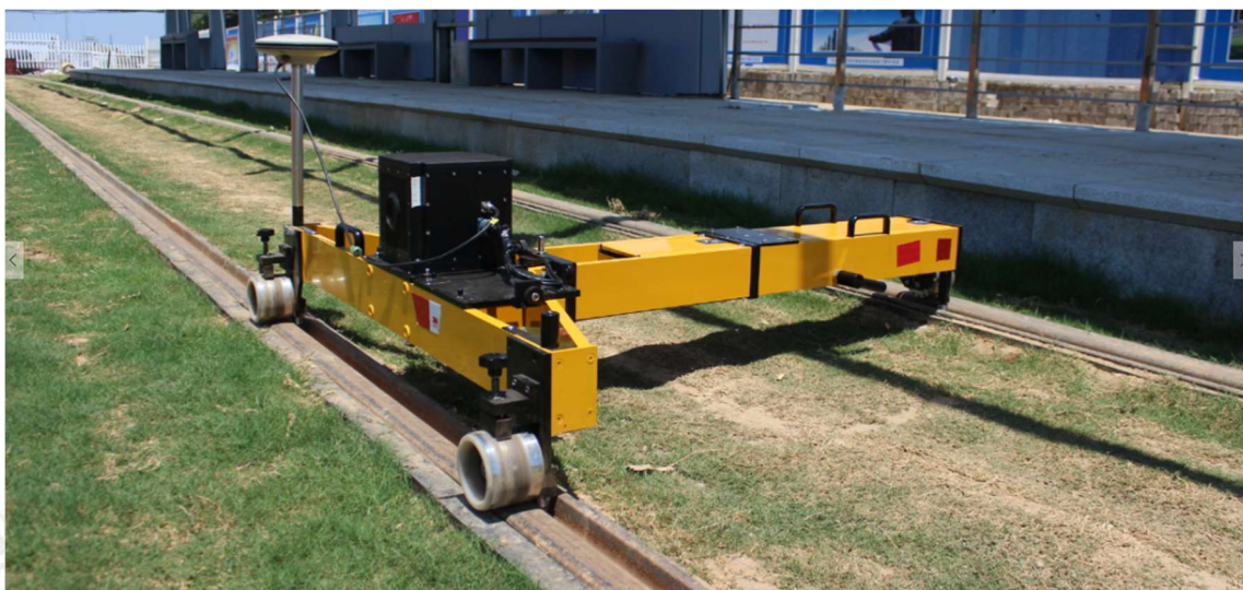
图 5-1 A-INS 铁路轨道几何状态测量系统（简称 A-INS 轨检小车）
